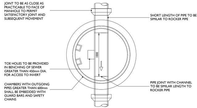
**PRECAST RING MANHOLE - PLAN**
