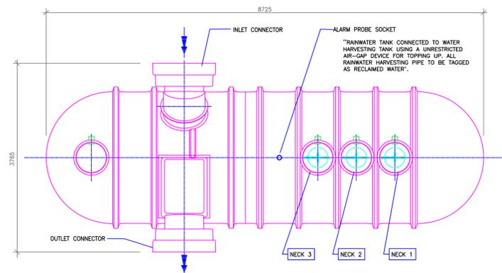
**STANDARD RAINWATER HARVESTING TANK - PLAN**
